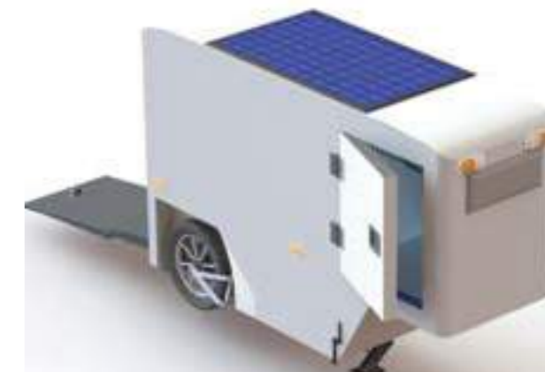
Afbeelding 4.10: Model van de verbeterde koel-vriestrailer.
