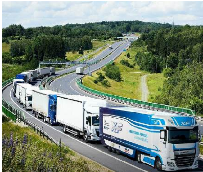
Fig. 8 Onder leiding van TNO heeft een consortium van alle Europese truck fabrikanten in het ENSEMBLE project een standaard ontwikkeld, die het mogelijk maakt in Europa truck platooning te gaan toepassen
